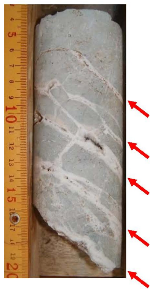
【地熱流体の通路】 葛根田蒸気基地 深度1700m付近
